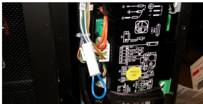
Figure 19.c Connectez le câble de raccordement CPI
