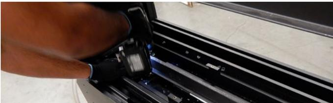
2. Desserrez les 4 vis de fixation de la bande de brûleur sur les supports.
