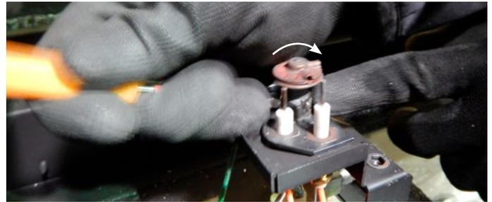
5. Utilisez un tournevis pour détacher la pince à ressort du capot du pilote.
