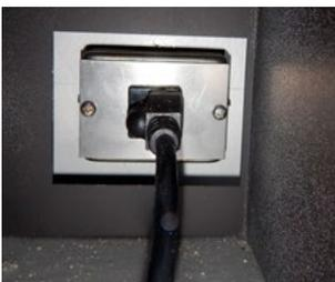
2. Débrancher le PPO de la carte située sous l'ensemble pilote. Débrancher la terre et retirer complètement le tiroir.
