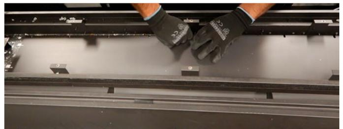
7. Retirer la plaque métallique du fond de la chambre de combustion.
