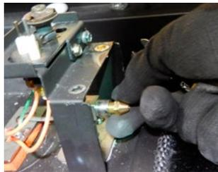
4. Utilisez un tournevis 3/8 "pour desserrer l'orifice de gaz NG et remplacez-le par un orifice de propane compris dans l'emballage.
