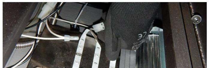
5. Brancher le connecteur du boîtier de commande au faisceau du ventilateur.
