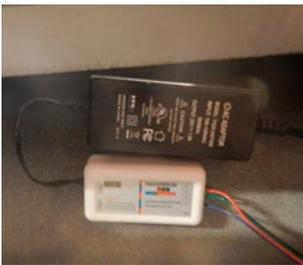
1. Fixez le récepteur de diode électroluminescente et l'adaptateur secteur à la face intérieure inférieure du foyer avec des bandes de velcro.
