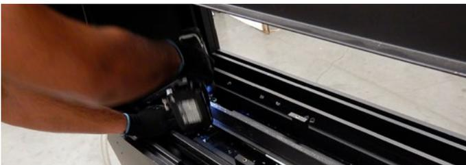
4. Desserrer les 4 vis de fixation de la bande de brûleur sur les supports.
