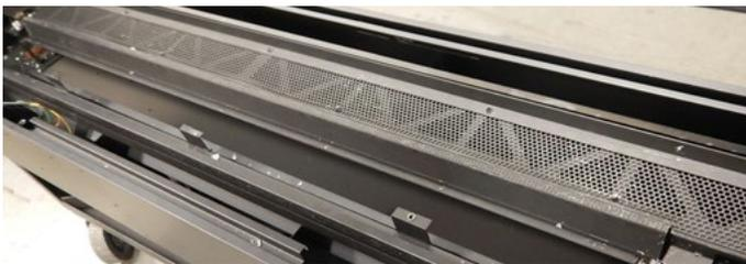
3. Les plateaux peuvent maintenant être retirés de la chambre de combustion.
