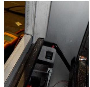
5. Débrancher le commutateur Marche / Arrêt et le câble d'alimentation à travers le cadre du tiroir. Installez dans l'espace sur le mur intérieur gauche.
