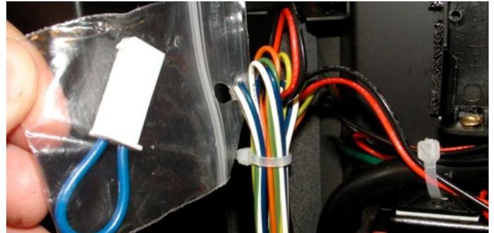
2). Retirez le sac contenant le câble de jonction du faisceau de câbles connecté au contrôleur comme indiqué dans la figure 19.
