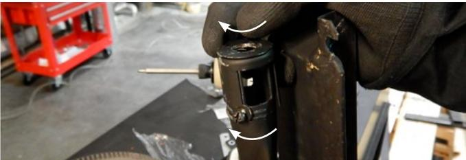
3. Desserrez la vis qui maintient l'ouverture du venturi. Faites glisser le couvercle venturi de sorte que l'ouverture est à la largeur maximale. Resserrer la vis.
