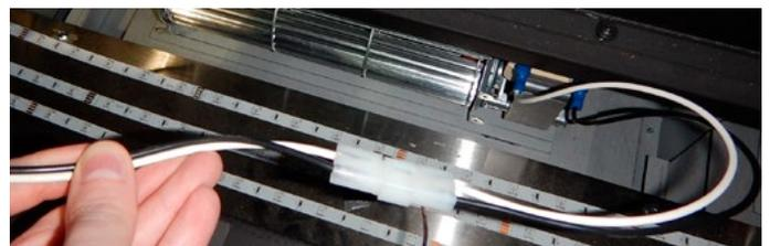
6. Connectez les ventilateurs aux connecteurs du faisceau, retirez les fils de la bande LED.
