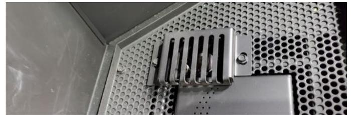
Figure 13. Retrait du couvercle de la veilleuse
