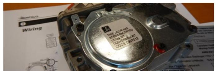
**Figure 13.k** Étiquette de conversion sur la soupape
