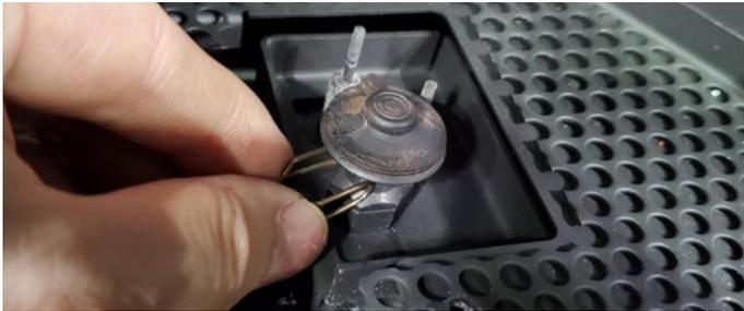
**Figure 13.d** Retrait de la sauterelle de fixation
