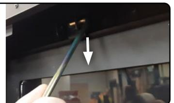
Figure 21.d Tirer sur les verrous de la porte
