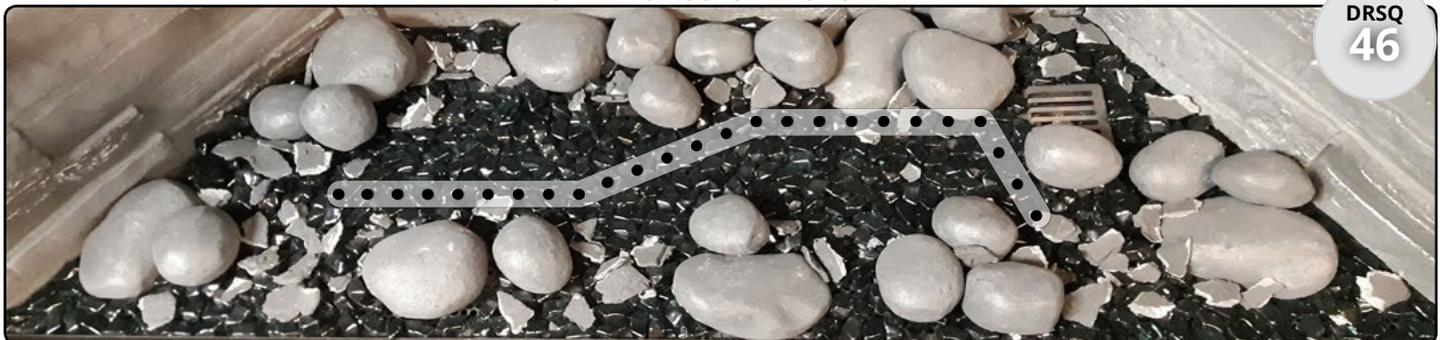
Couvrez le brûleur d'une seule couche de charbons. Disposez les braises sur le dessus du plateau du brûleur. NE couvrez PAS la veilleuse avec des bûches.
