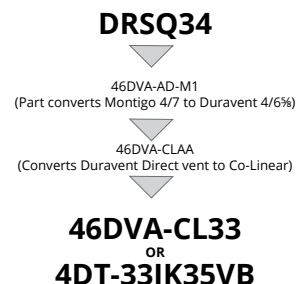
Figure 99.b Configuration ventilée arrière colinéaire.
